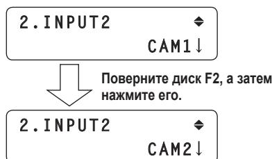
В видеомикшере есть пять входных линий: от INPUT1 до INPUT5. Выполните предусмотренные выше действия для установки удаленных камер для входных линий, после чего можно выполнять управление удаленными камерами.
