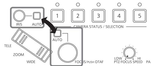
Au menu [SETUP], sélectionner [OPERATE] et afficher [FOCUS/IRIS]. Puis sélectionner "STANDARD" ou "EXCHANGE".
