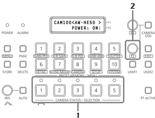
Mise sous tension des caméras en même temps que la mise sous tension de l'appareil
