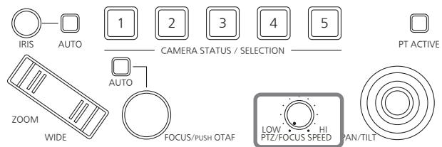
Au menu [SETUP], sélectionner [OPERATE] et afficher [SPEED TARGET]. Si P/T est sélectionné, le réglage de vitesse se limite uniquement à Pan et Tilt.
