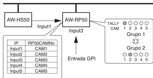
En respuesta a las entradas 1 a 5 procedentes de la entrada GPI, los indicadores de señalización CAM1 a CAM5 se encienden en color rojo, y la instrucción ON de señalización se envía a las cámaras remotas pertinentes. Sólo CAM1 a CAM5 sirven como la señalización de entrada GPI.
