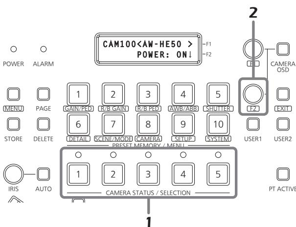
Включение питания камер одновременно с включением питания данного устройства
