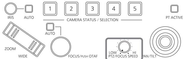
В меню [SETUP] выберите подменю [OPERATE] и отобразите пункт [SPEED TARGET]. При выборе опции Р/Т скорость регулировки ограничивается только поворотом и наклоном. В таком случае для скорости трансфокации и фокусировки фиксируется значение, установленное сразу до выбора опции Р/Т.
