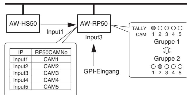
Als Reaktion auf die Eingaben 1 bis 5 vom GPI-Eingang leuchten die Tally-Lampen CAM1 bis CAM5 rot auf, und die Anweisung Tally ON wird zu den betreffenden Netzwerkkameras gesendet.
