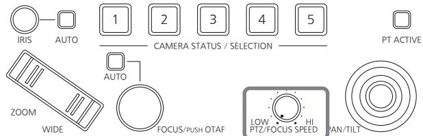
Dal menu [SETUP], selezionare [OPERATE] e visualizzare [SPEED TARGET]. Selezionando P/T, la regolazione della velocità interessa solo la panoramica orizzontale e la panoramica verticale.
