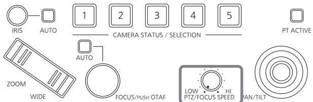
Wählen Sie [OPERATE] im Menü [SETUP], und zeigen Sie [SPEED TARGET] an. Bei Wahl von P/T beschränkt sich die Geschwindigkeitseinstellung auf Schwenken und Neigen. In diesem Fall wird die Zoom- und Fokussiergeschwindigkeit auf die Geschwindigkeit festgelegt, die unmittelbar vor der Wahl von P/T eingestellt wurde.
