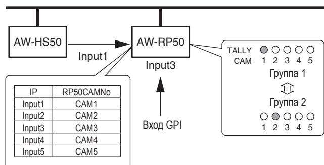
В ответ на входные сигналы от 1 до 5, полученные с входа GPI, сигнальные индикаторы от CAM1 до CAM5 загораются красным цветом и на соответствующие удаленные камеры отправляется команда сигнальной метки ON.
