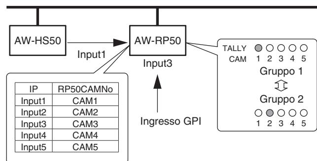
In risposta agli ingressi da 1 a 5 di GPI Input, gli indicatori tally da CAM1 a CAM5 si accendono in rosso e l'istruzione tally ON viene inviata alle videocamere remote pertinenti. Solo da CAM1 a CAM5 servono come tally di GPI Input. Pertanto, se si seleziona un gruppo di videocamere diverso da No.1, gli indicatori tally si spengono.
