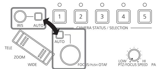
Wählen Sie [OPERATE] im Menü [SETUP], und zeigen Sie [FOCUS/IRIS] an. Wählen Sie dann entweder "STANDARD" oder "EXCHANGE".
