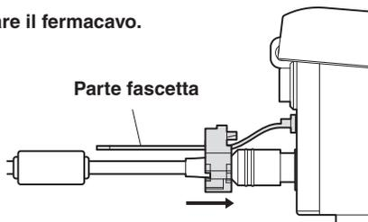
Afferrare la parte della fascetta, spingere il fermacavo finché smette di muoversi e fissarlo poi saldamente.
