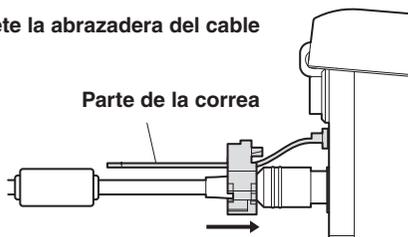
Sujete la parte de la correa, deslice la abrazadera del cable hasta que deje de moverse y luego asegúrela firmemente.
